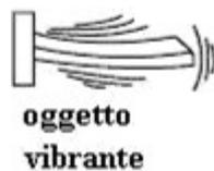
Beobachtet man ein Objekt während einer Schwingungsbewegung (Abbildung oben), so kann periodische Bewegungen beobachten; die Zeit zwischen zwei Durchgängen eines Punktes zur Referenzposition (Gleichgewichts- oder Ausgangslage) wird als Periode (oder Zyklus) [s] bezeichnet.
