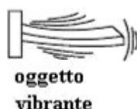
Si se observa un objeto en movimiento vibratorio (figura anterior) se pueden observar movimientos periódicos; el tiempo transcurrido entre dos pasadas de un punto a la posición de referencia (equilibrio o posición inicial) se denomina periodo (o ciclo) [s].
